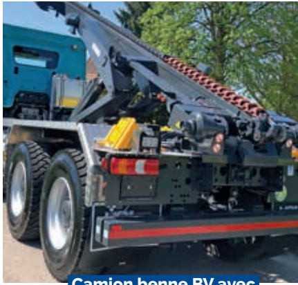
Camion benne BV avec systèmes de conteneur VDL
